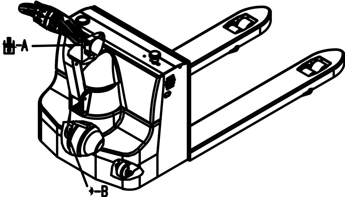
Отверстие для заливки гидравлического масла
