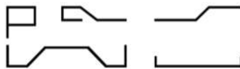
Рис. 5 Формы изгиба арматуры
